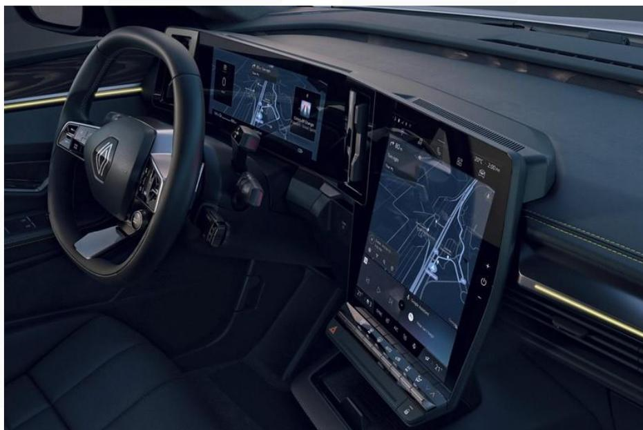
O ecrã OpenR é construído usando vidro reforçado, para garantir um acabamento mais robusto, que resulta agradável ao toque e ao olhar. O brilho do ecrã e a refletividade da luz foram otimizados para assegurar uma boa visibilidade, mesmo sob luz solar intensa; melhorada ainda pelo revestimento antirreflexo. Assim sendo, a tradicional pala protetora do painel de instrumentos foi removida, já não sendo necessária, poupando espaço e tornando o aspeto final ainda mais “limpo” e moderno.
